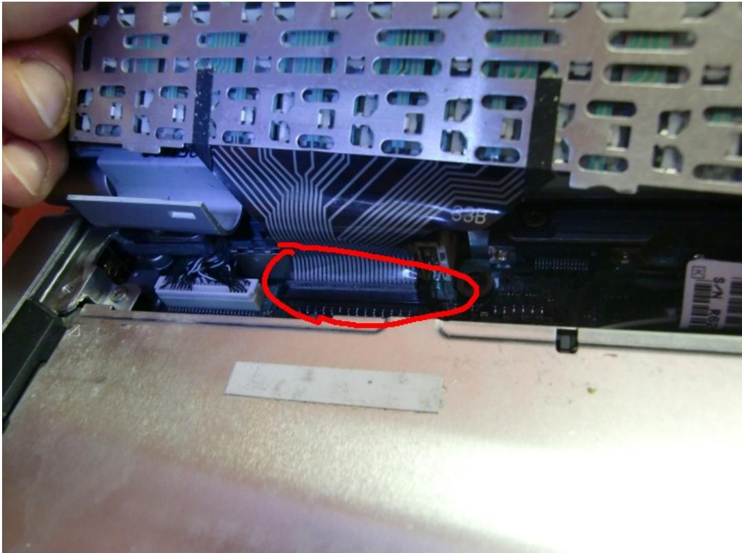
Die drei Schrauben lösen, damit man das Abschirmblech abheben kann:
