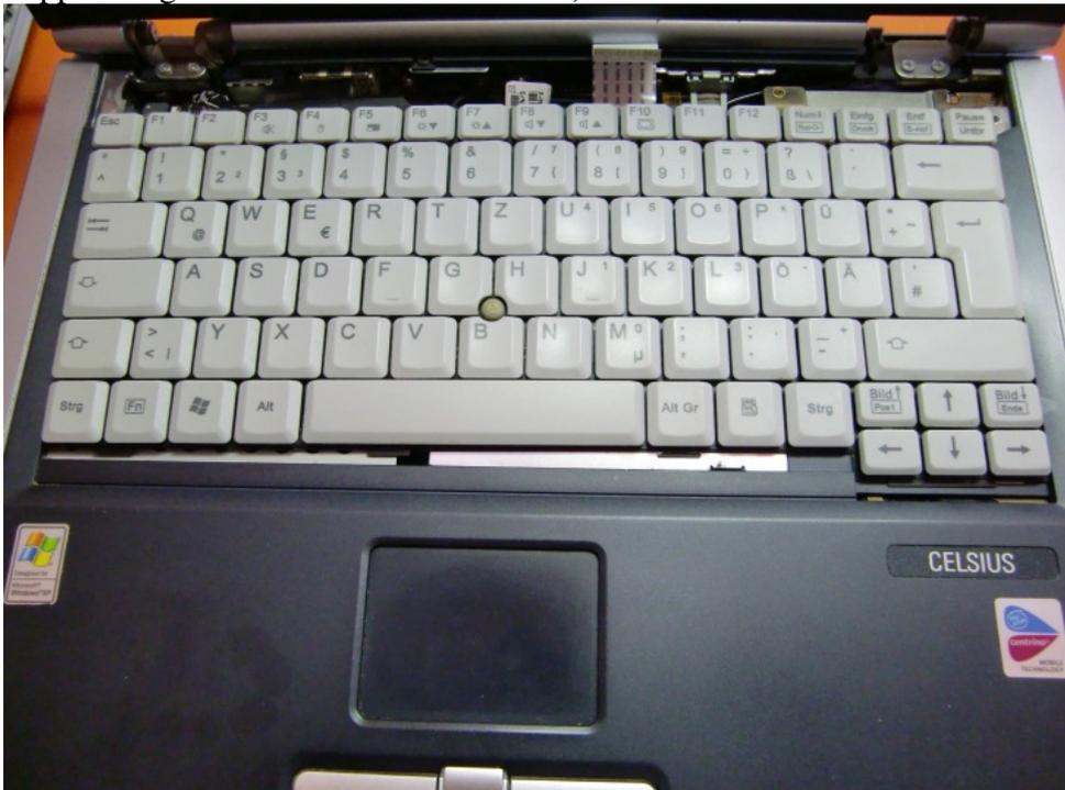
Trackpointanschlußfolie entfernen, dazu den kleinen Klemmhebel anheben und die Folie nach oben abziehen.
