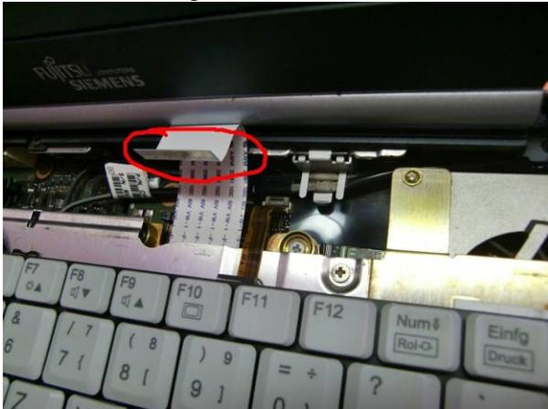
Als nächstes wird die Tastatur entfernt, dazu etwas anheben (sie könnte am Untergrund mit doppelseitigem Klebeband verklebt sein) und leicht nach hinten ziehen:
