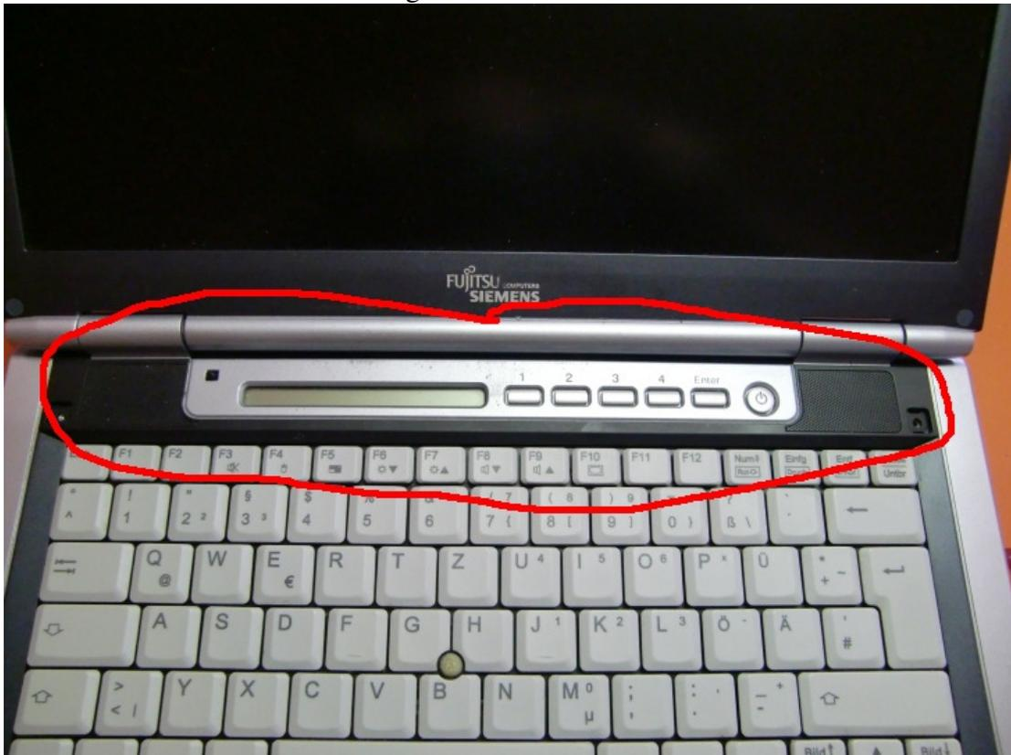
Dazu den Deckel weit aufklappen, an den Ecken links und rechts die Abdeckung vorsichtig aushebeln und hinten die Clips links und rechts anheben.
