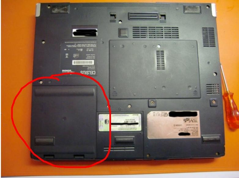
und Festplatte (dazu die 2 Schrauben herausdrehen und die Platte herausziehen):
